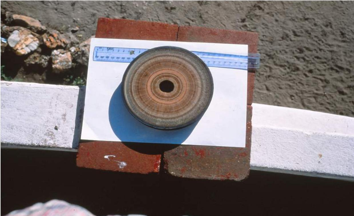
Ici : dépôts calcaires à l'intérieur d'un tuyau dans un forage au Kenya
